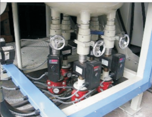
雙塔壓力罐：連續壓入式珠擊
